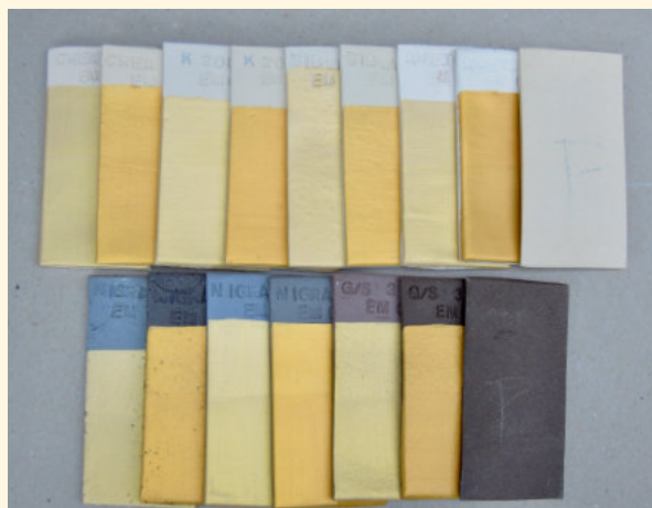
▲ Proefplaatjes in tweetallen dezelfde klei met goudengobe, voor en na het bakken op 1100 °C
