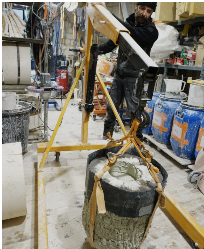
Met een kraan hijs ik de smeltkroes in de elektrische oven voor het drogen en de eerste stook op 1000 °C.
