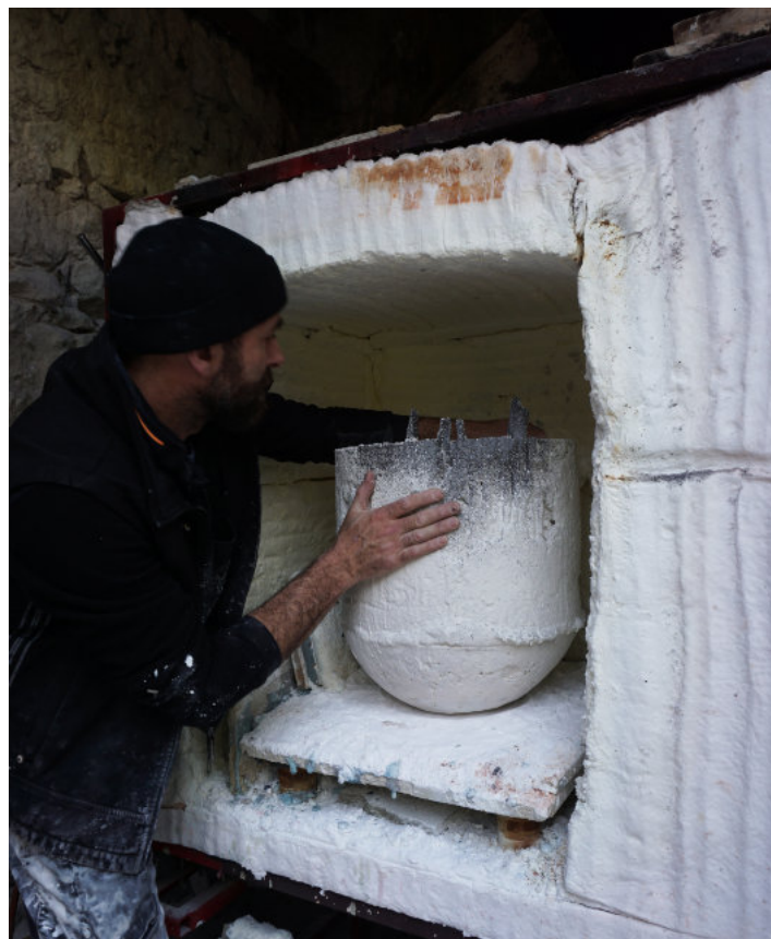
Dan wordt de de smeltkroes in de gasoven geschoven. De reducerende stook bij 1300 °C duurt 10 uur.
