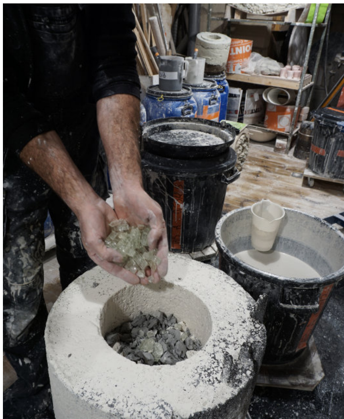
Ik vul de smeltkroes met blokken droog glazuur en stukken glas.
