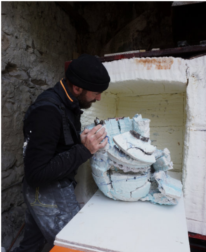
Na twee dagen afkoelen kan de oven open.
